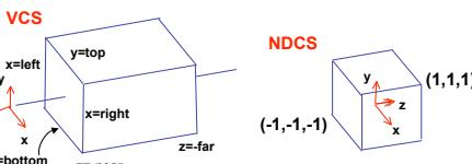
$$\begin{bmatrix} x' \\ y' \\ z' \\ 1 \end{bmatrix} = \begin{bmatrix} e & 0 & 0 & f \\ 0 & a & 0 & b \\ 0 & 0 & c & d \\ 0 & 0 & 0 & 1 \end{bmatrix} \begin{bmatrix} x \\ y \\ z \\ 1 \end{bmatrix}$$
