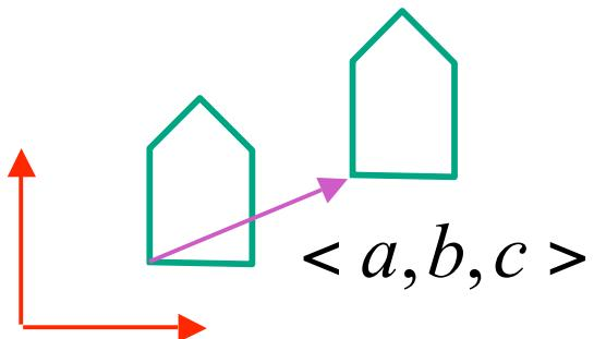
$$\begin{bmatrix} x' \\ y' \\ z' \\ 1 \end{bmatrix} = \begin{bmatrix} 1 & 0 & 0 & a \\ 0 & 1 & 0 & b \\ 0 & 0 & 1 & c \\ 0 & 0 & 0 & 1 \end{bmatrix} \begin{bmatrix} x \\ y \\ z \\ 1 \end{bmatrix}$$
