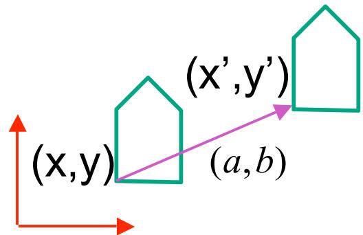
$$\begin{bmatrix} x \\ y \end{bmatrix} + \begin{bmatrix} a \\ b \end{bmatrix} = \begin{bmatrix} x + a \\ y + b \end{bmatrix} = \begin{bmatrix} x' \\ y' \end{bmatrix}$$
