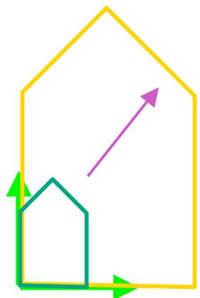
$$\begin{bmatrix} x' \\ y' \\ z' \\ 1 \end{bmatrix} = \begin{bmatrix} a & 0 & 0 & 0 \\ 0 & b & 0 & 0 \\ 0 & 0 & c & 0 \\ 0 & 0 & 0 & 1 \end{bmatrix} \begin{bmatrix} x \\ y \\ z \\ 1 \end{bmatrix}$$
