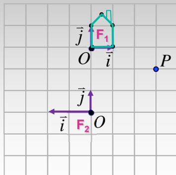
$$\begin{bmatrix} x \\ y \end{bmatrix}_2 = \begin{bmatrix} -0.5 & 0 & 0 \\ 0 & 1 & 3 \end{bmatrix} \begin{bmatrix} x \\ y \\ 1 \end{bmatrix}_1$$
