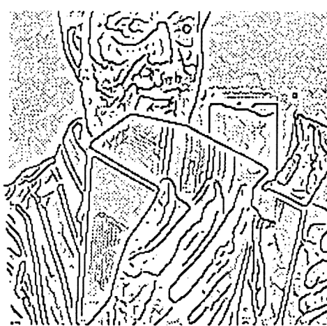
(d) Canny's detecting result, \sigma = 1.5
