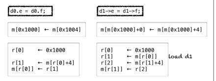
struct D { int e; int f; **}**; d0.e = d0.f;d1->e = d1->f: r[0] ← 0×1000 r[0] ← 0x1000 r[1]  $\leftarrow m[r[0]]$ load d1  $\leftarrow m[r[0]+4]$  $\leftarrow m[r[1]+4]$ r[1] r[2]  $m[r[0]] \leftarrow r[1]$  $m[r[1]] \leftarrow r[2]$ ld \$0x1000, r0 # r0 = address of d0 ld \$0x1000, r0 # r0 = address of d1 ld (r0), r1 # r1 = d1 ld 4(r1), r2 # r2 = d1->f st r2, (r1) # d1->e = d1ld 4(r0), r1 # r0 = d0.f st r1, (r0) # d0.e = d0.f # d1->e = d1->f
